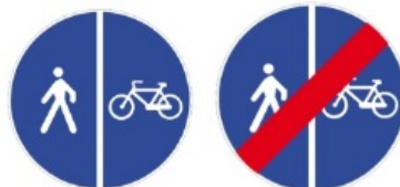
PISTA CICLABILE CONTIGUA AL MARCIAPIEDE
